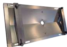
PAW-WTRAY Kondensvatten droppplåt av Mangelis för markställning PAW-GRDSTD40 med 4 m värmekabel inklusive 3 °C termostat.
